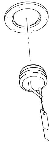
惰化系统冷风道排气口 停放保护-堵塞
