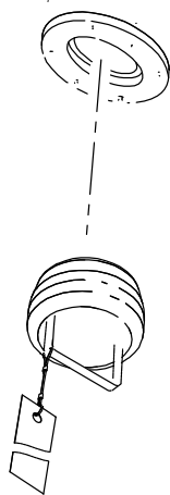
惰化系统富氧气体排放口停放 保护-堵塞
