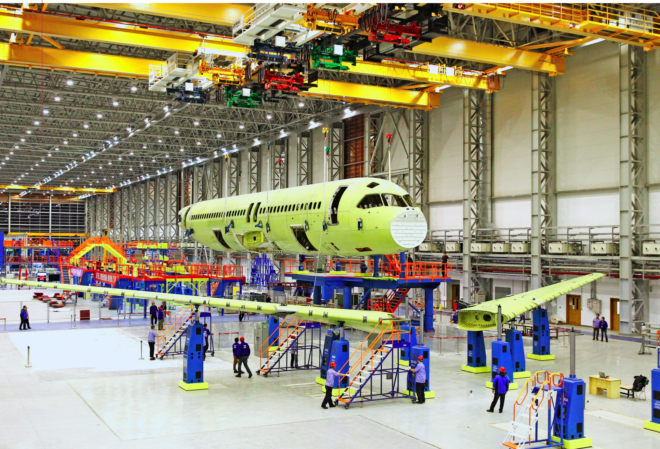
2014 年 11 月 30 日，C919 飞机首架机 进入机身与机翼对接阶段 图 | 徐炳南
