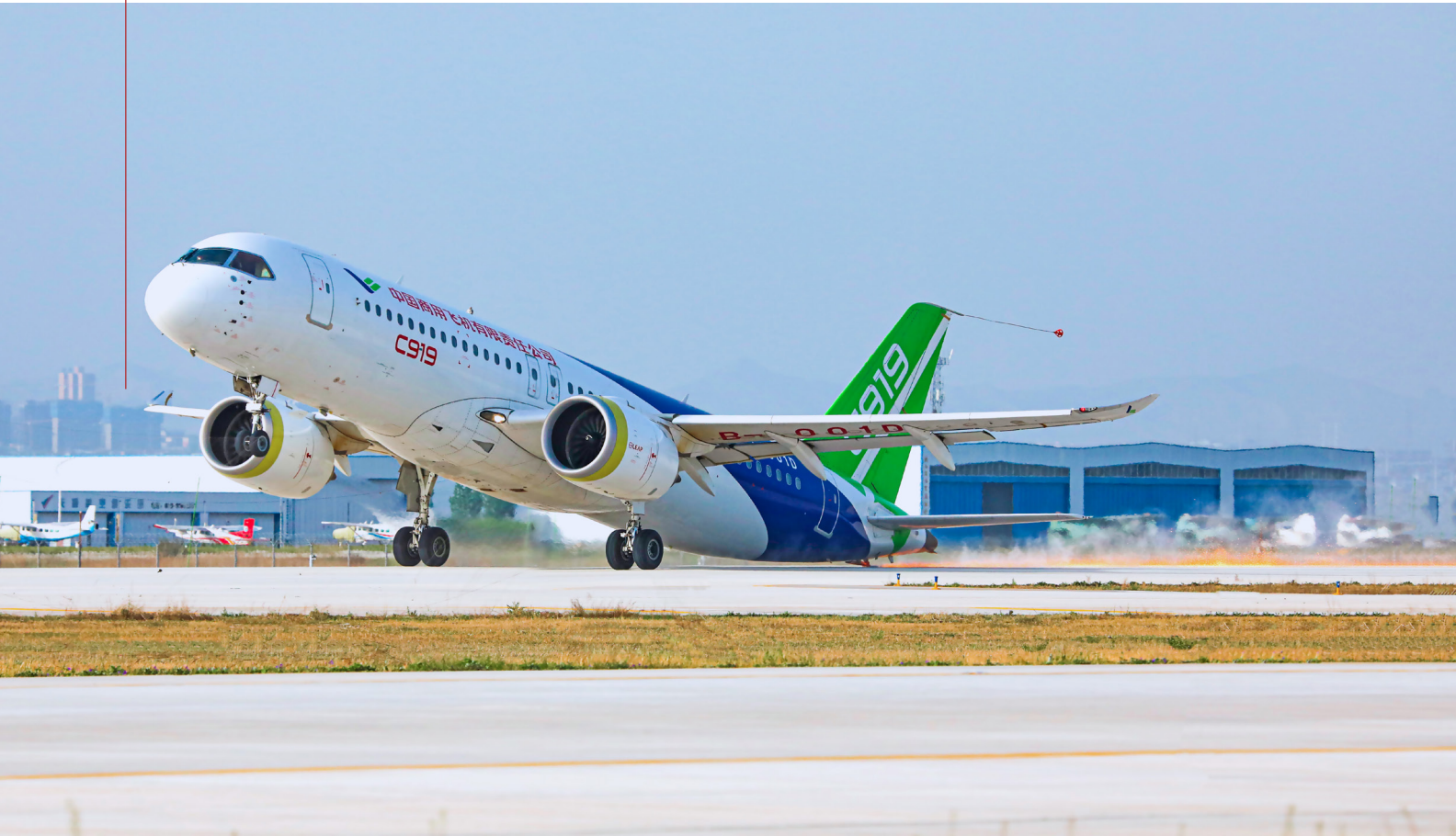
2022 年 4 月，C919 飞机开展最小离地速度试飞 这是首次由中国试飞机组完成最小离地速度试飞 图 | 王脊梁
