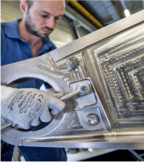
图 1 | A350 XWB 飞机增材制造钛合金连接架
