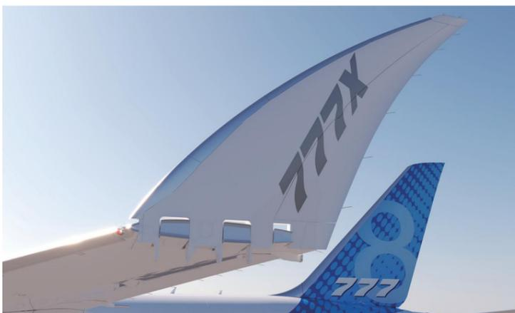
▼ 图 2 | 扩张型铰链折叠翼尖示意图
