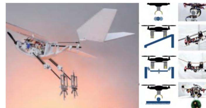
▲ 扑翼、固定翼和旋翼无人机实现了在不同地形起降、行走、起跳和物体抓取的能力
