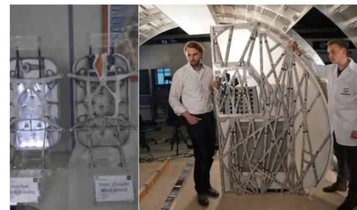
▲ Sogeclair 和空客公司采用新制造和设计方式生产的仿生结构飞机部件 (图片来源: 维捷)
