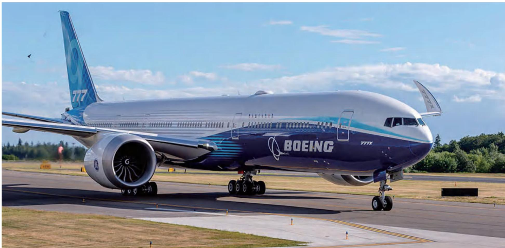
运营，但是仍可能带来额外的认证要求、审批手续和机场运营需求（如飞行前进行跑道外来巡查）；同时，翼尖放下后其气动特性近似为无翼尖设备的一般客机机翼，与具备翼梢小翼等翼尖设备的机型相比，缺少了对气流三维效应的抑制效果，同时低速状态下的横向稳定性能也有不如。而且，单次试飞成功尚不能说明该装置长期使用的经济性、可靠性和可维护性，且其铰链结构的转折处为直角过渡且凹凸不平，可以预见此处的空气动力学性能不能够满足在飞行状态下使用的需求。
