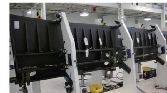
舱门等零件制造。液体成型工艺的应用，大大降低了上述复杂结构零件的制造成本和装配要求。
