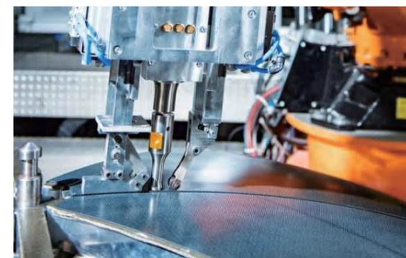
▲ 图 6 | 热塑性复合材料的超声波焊接
