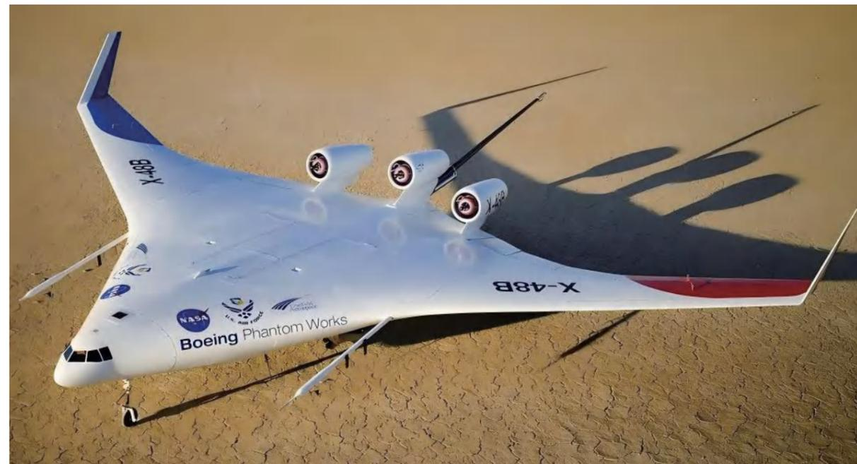
在全球航空研发进程中，主制造商如波音（X-48B 验证机，用于布局与控制律验证）、空客（Maveric 验证机，用于控制律鲁棒性研究）、洛克希德·马丁（X-56 验证机，用于气弹与颤振试验）等公司都曾采用缩比验证机进行飞行试验。
