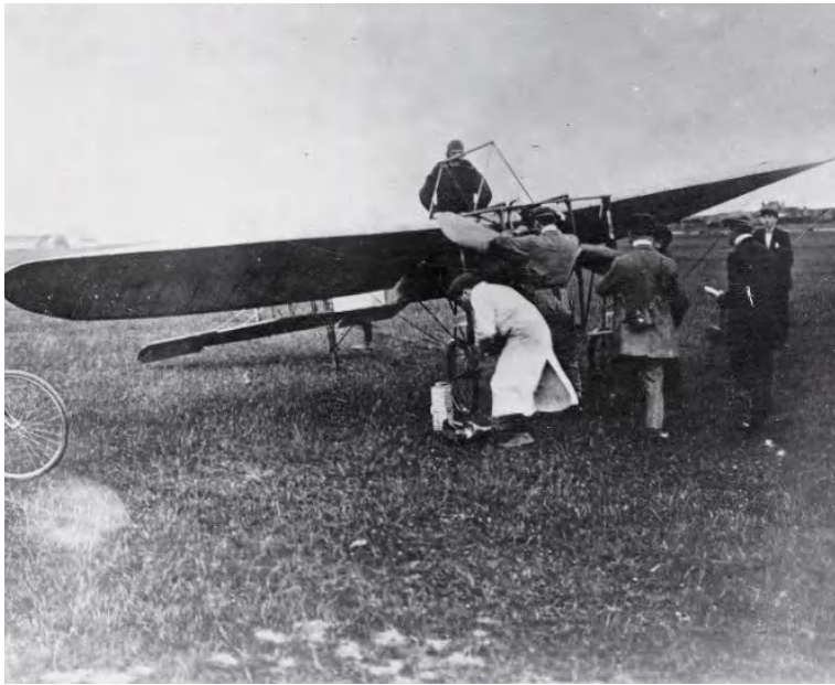
▲ 图 | 1909 年 7 月 25 日，路易·布莱里奥的 XI 型单翼机的安扎尼发动机启动
