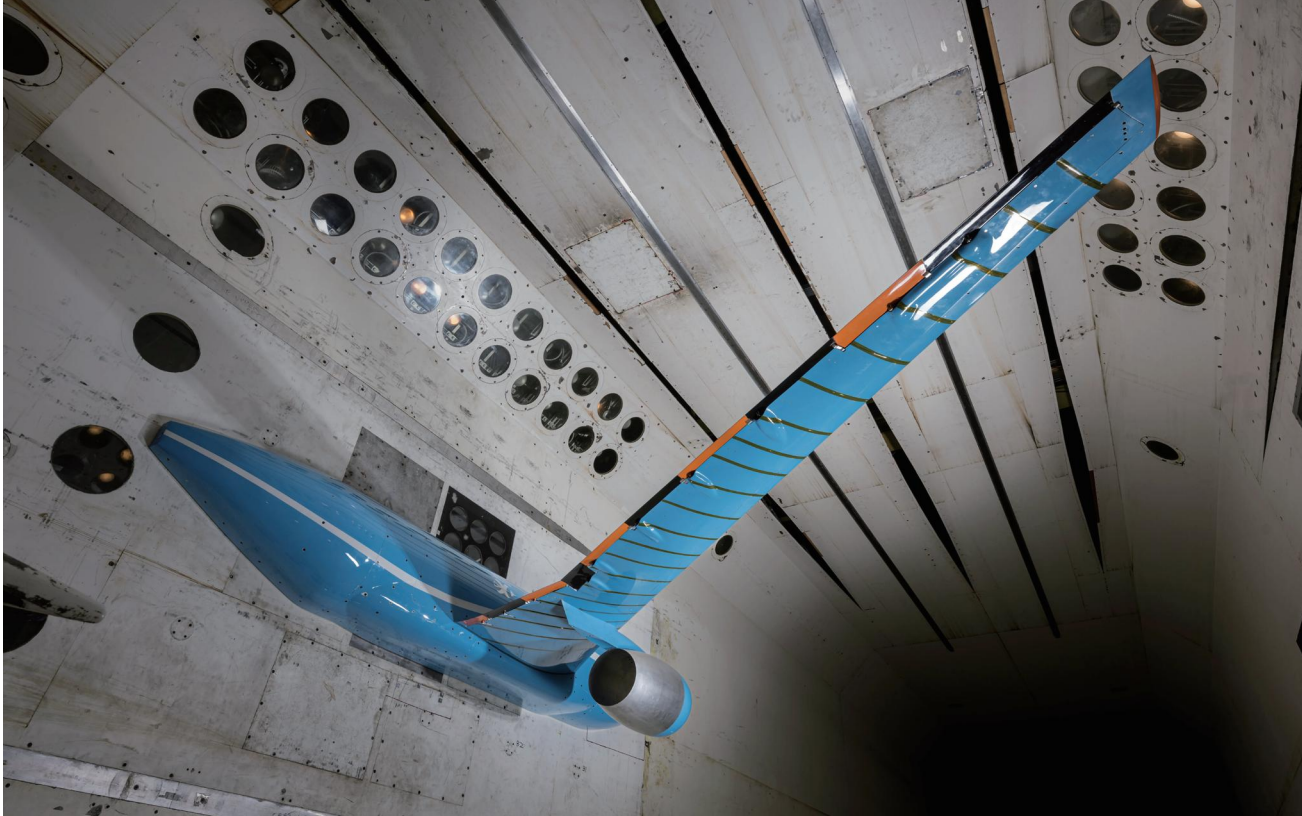
▲ 图 2 | 用于风洞实验的模型实物
