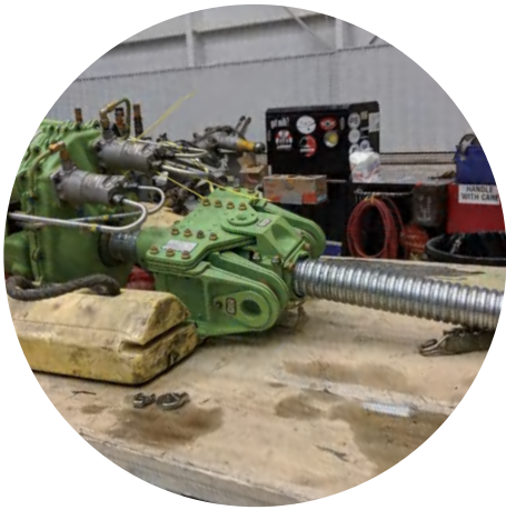
▲ 图 4 | 典型窄体、宽体飞机水平安定面配平作动器
