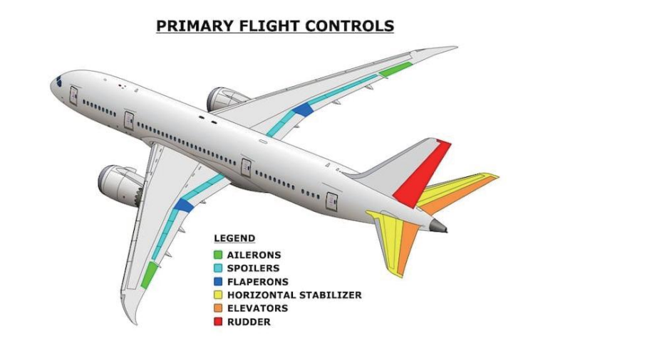
▲ 图 4 | 美国主制造商第二款电传操纵飞机飞控系统控制舵面示意
