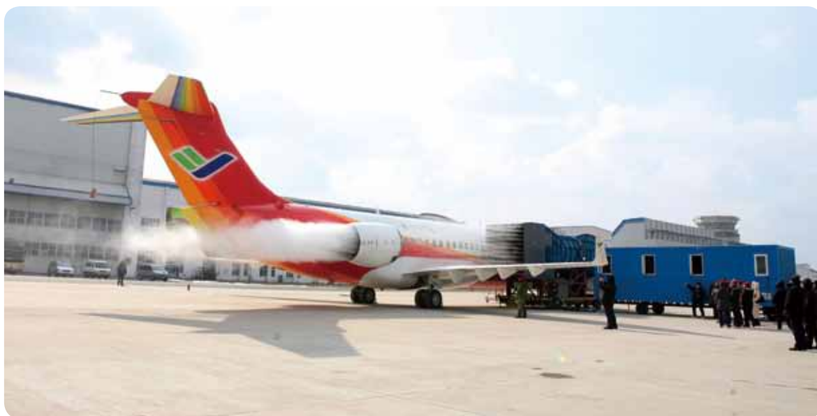
ARJ21-700 飞机进行短舱防冰试验
