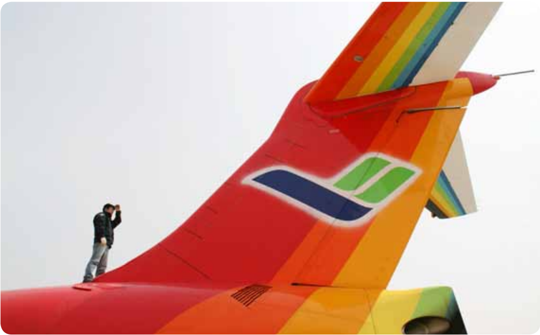
ARJ21-700 飞机开展自然结冰试验试飞
